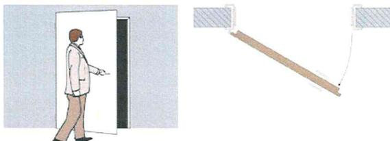
Sind die Bänder der geschlossenen Tür linker Hand zu sehen, ist die Tür links angeschlagen (DIN-L)
