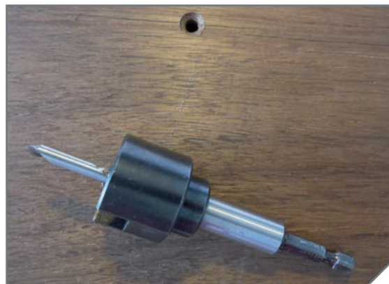
Spezialbohrer mit eingebautem Versenker ermöglichen eine saubere und gleichmäßige Verschraubung.
