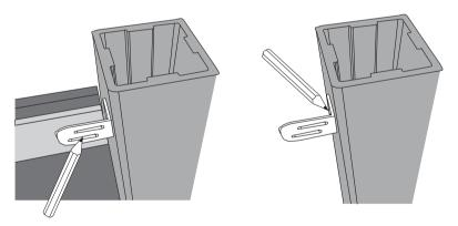
Markieren Sie die Stellen für die Schraublöcher an den Querträgern des Zaunelements und am Pfosten.
