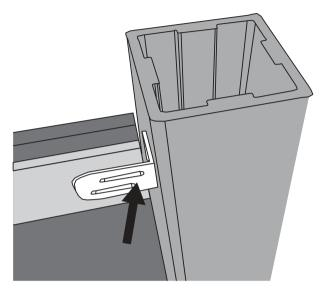
Legen Sie die L-Halterung in der entsprechenden Position an den Pfosten und dem Alurahmen.
