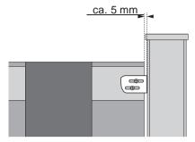
Beachten Sie für die Ausrichtung der Zaunelemente, dass Sie zwischen Pfosten und Zaunelement einen Abstand von mindestens 5 mm einhalten.
