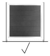
Es wird nachdrücklich empfohlen, den Zaun so zu montieren, dass er *nicht* auf dem Boden aufliegt.
